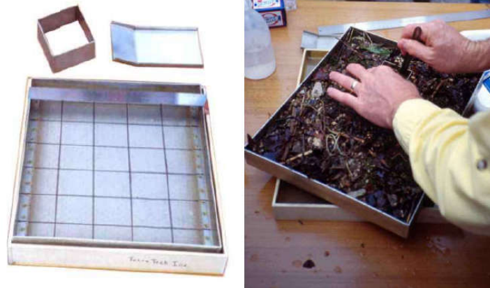
Fig.15. Sub eșantionarea probelor cu dispozitiv Caton
