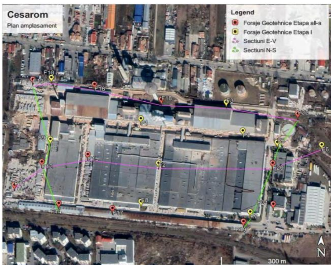
Figura 7. Poziționarea forajelor pe amplasamentul studiat Sanex
