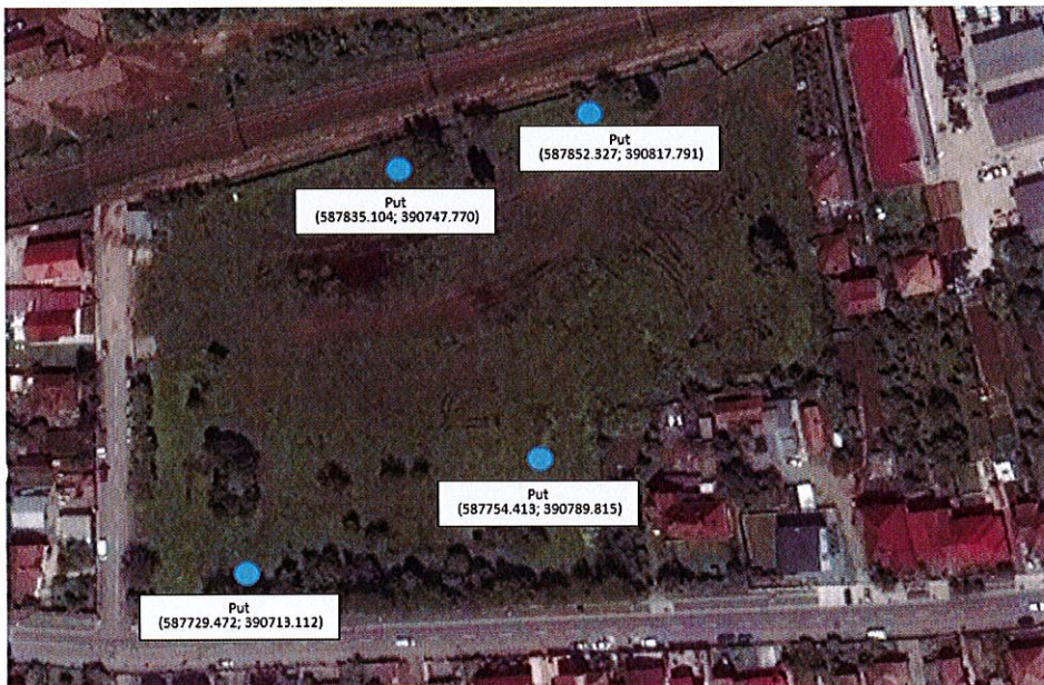
Figura nr. 1 – Plan de situație cu amplasamentul puturilor de monitorizare existente în depozitul de produse petroliere Cluj 2 (conform anexa apă subterană elaborat de către ALS Life Sciences România)
