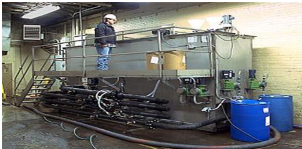
Figura 13. Instalatia de flotatie
