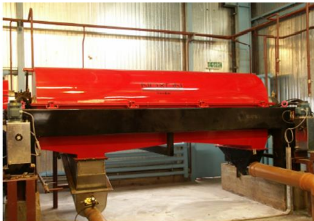
Figura 15. Unitate de deshidratare tip decantor centrifugal
