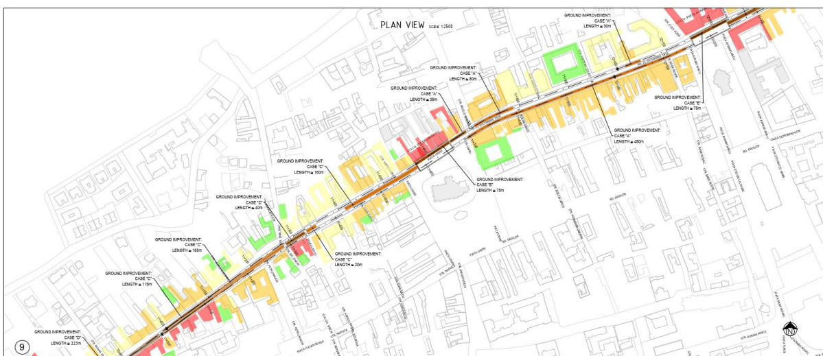
Figura 3.6-37. Daunele estimate pentru clădirile învecinate și aplicarea măsurilor de diminuare a daunelor - vedere 9
