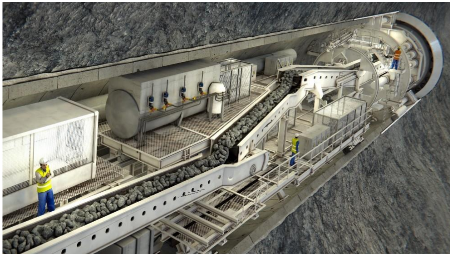
Figura 10.1-10. Benzi transportoare pentru transportul materialului excavat
