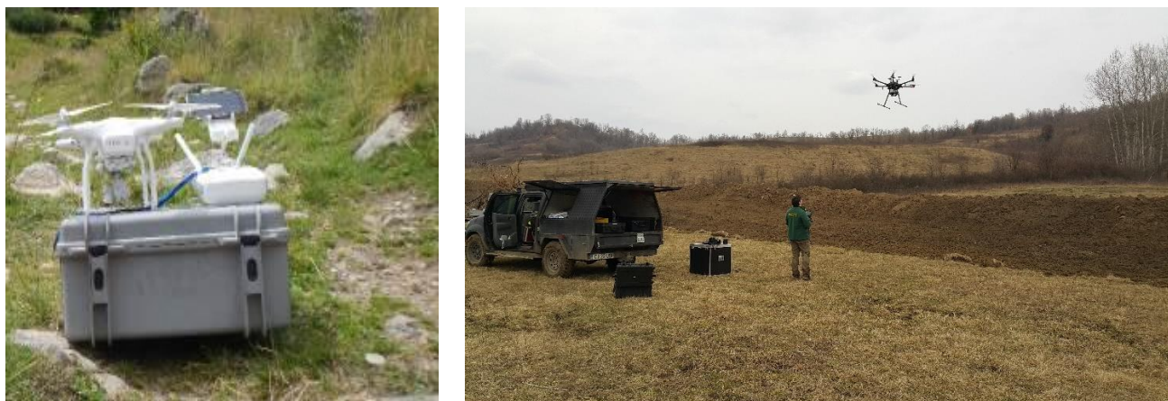
Figura 18. Drona DJI Phantom III-Advanced pregătită de zbor (stânga); Dronă DJI Matrice 600 PRO cu unitate LiDAR
