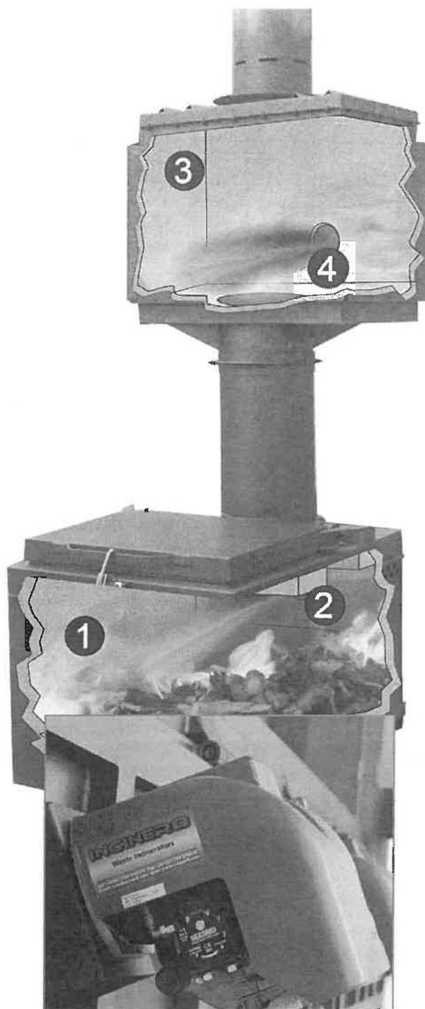
Coșul de fum este montat la ieșirea din camera secundară. Acesta este realizat din oțel inoxidabil de calitate superioară, rezistent la temperaturi înalte. Coșul de fum asigură eliminarea eficientă a gazelor de ardere. Înălțimea coșului de fum este în funcție de solicitările beneficiarului.
