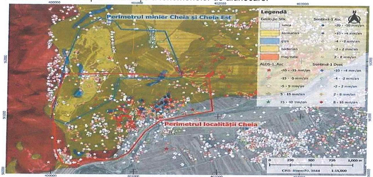
Vectorii de viteză indică deformații în lungul versantului de 40 mm/an aproape pe toată extinderea arealului studiat și două zone unde deformațiile ating 60 – 70 mm/an. Vitezele mai mari de obicei se corelează cu creșterea locală a pantei terenului. Se pot observa valori mai mari în zona centrală și central nordică a localității și descreșterea magnitudinii în celelalte zone. În special în partea sud-vestică a satului sunt areale mai stabile.
