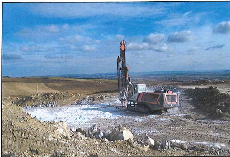
Amplasarea găurilor de sondă în lungul frontului se poate face pe un rând, pe două sau mai multe rânduri, funcție de condițiile concrete din teren.
