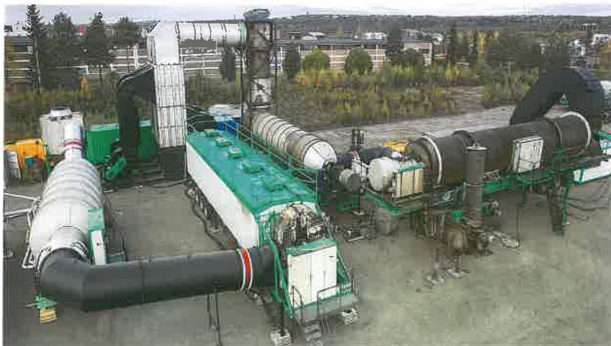
Figura 6. Aspect general al unui ansamblu de echipamente de desorbție termică Savaterra
