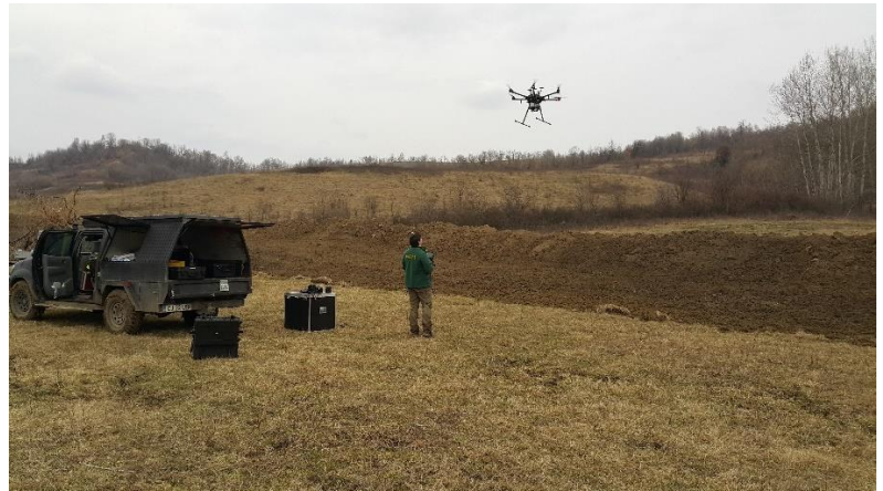
Figura 7. Drona DJI Phantom III-Advanced pregătită de zbor (stânga); Dronă DJI Matrice 600 PRO cu unitate LiDAR
